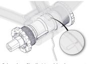
Schrauben Sie die Verschlusskappe entgegen dem Uhrzeigersinn am Tretlager fest; verwenden Sie dafür das Spezialwerkzeug. Erforderliches Drehmoment: 30N.m. (max.).
